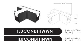
Cople en forma de T iluminado, 10 W, aluminio acabado negro con cubierta de policarbonato difuso, para luminarios de la serie ILUINTB, 85 - 277 Vca, conexión horizontal, IP20
