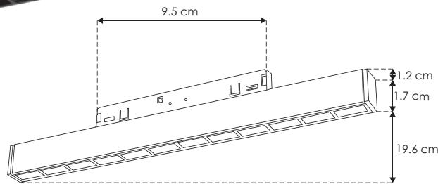
**NOTA:** Compatible con fuentes atenuables modelos ILUDA5EN160W24, ILUDA5EN1100W24, ILUDA5EN1200W24, ILUDA5EN1350W24 (Por la curva de atenuación de este luminario, no se recomienda combinarlo con otros modelos distintos al usar una fuente de poder atenuable)
