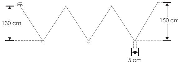
**Material** Aluminio acabado negro**Lámpara** Luminario para suspender en techo**Ángulo de apertura** 38°**Color de luz** Blanco cálido**Alimentación** 100 - 240 V ca**Potencia** 12 W**2-3 step
