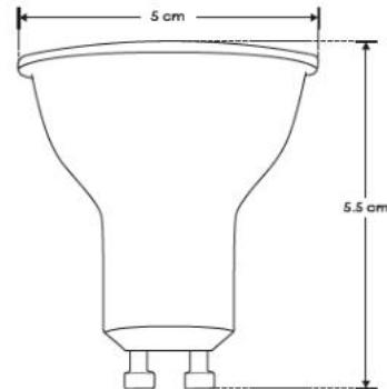
**Lámpara tipo dicroico con base GU10 y ángulo de 38°, atenuable (Compatible con dimmers tipo TRIAC).**
