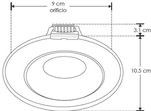
Este producto es usado como difusor de lámparas tipo MR16, GU10 o módulos de leds cuyo diámetro sea igual a 5 cm. Grado de protección IP20 (Para uso en interiores). Características de la base MR16 (incluida) 277 V ~ 35 W (0.28 A) máx. 50/60 Hz
