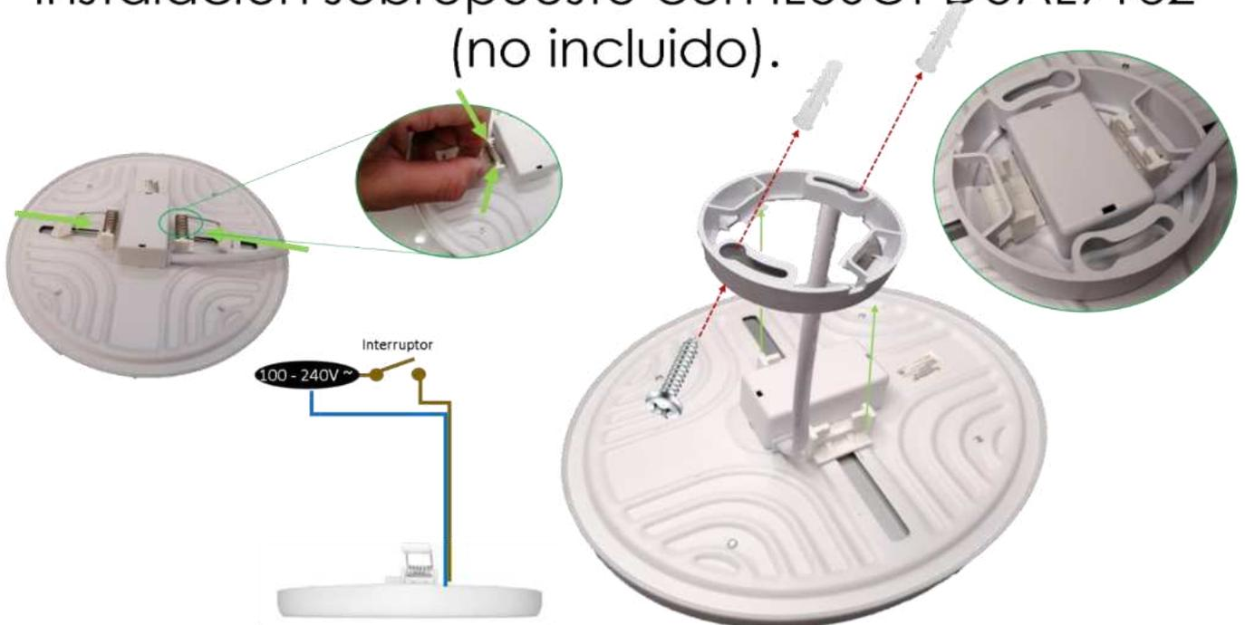
Ajuste los soportes laterales al mínimo y retire los resortes. Fije el ILUSOPDUAL9Y32 usando las pijas y taquetes incluidos. Realice las conexiones y aisle perfectamente. Inserte el luminario a presión. Encienda el luminario y pruebe su funcionamiento.
