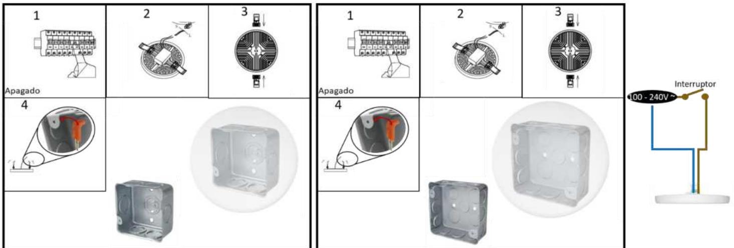
Apague la energía eléctrica. Realice las conexiones y aisle perfectamente. Ajuste los soportes laterales. Inserte el luminario y asegúrelo con los soportes laterales en las cejas de la caja. Encienda el Luminario y pruebe su funcionamiento.
