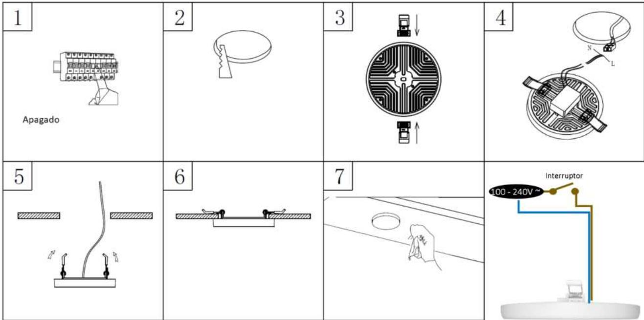
Apague la energía eléctrica. Haga un orificio de acuerdo con las especificaciones del luminario. Ajuste los soportes a la medida del orificio. Realice las conexiones eléctricas y aíse perfectamente. Inserte el luminario en el orificio y asegúrelo con los soportes laterales. Encienda el luminario y pruebe su funcionamiento.
