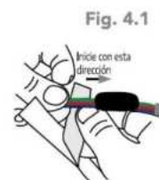
Fig. 1.4 Con los pasos anteriores se generó un sello que evitará el paso de humedad.
