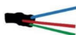
Fig. 1.4 Con los pasos anteriores se generó un sello que evitará el paso de humedad.
