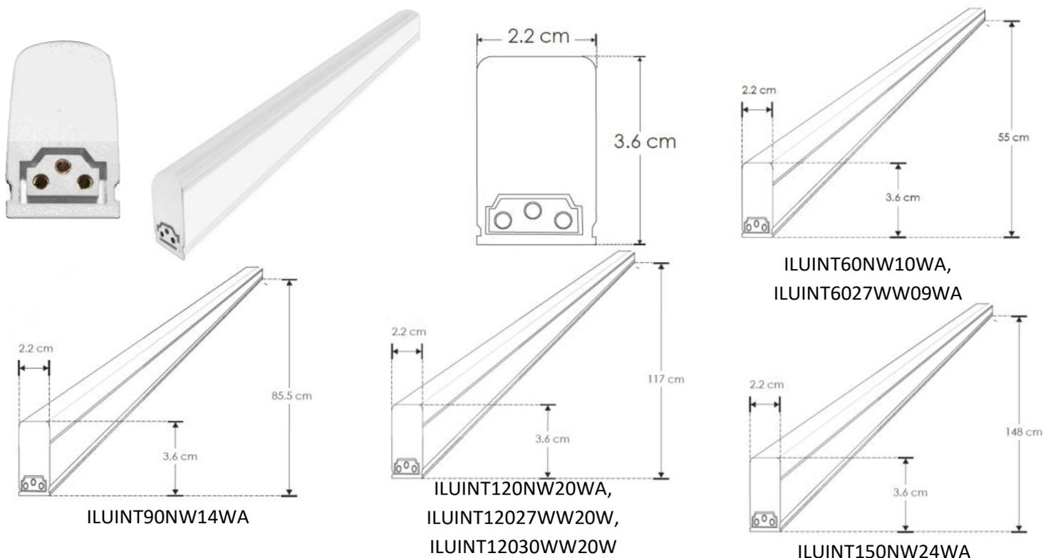
Este producto es usado como elemento de iluminación directa, indirecta en comercio residencia, muebles etc. fuente luminosa a base de leds de superficie 2835 interconectable aterrizada. Modelos con terminación A con controlador (driver) aterrizado.
