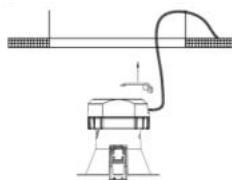
2. Levante la tapa del luminaire e inserte los cables de conexión. Coloque el luminaire (ILUMODPC8WWW, ILUMODPC8WNW o ILUMODPC8WW) en el difusor por la parte trasera.
