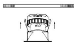
3. Inserte el difusor con el luminaire en el orificio y asegúrelo con los soportes laterales.
