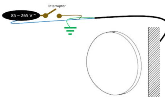
4. Fije el luminario a la base de sujeción y pase los cables de alimentación por el muro. Encienda la energía eléctrica y pruebe su funcionamiento.
