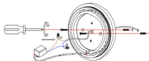
2. Fije la base de sujeción al muro usando pijas y taquetes.
