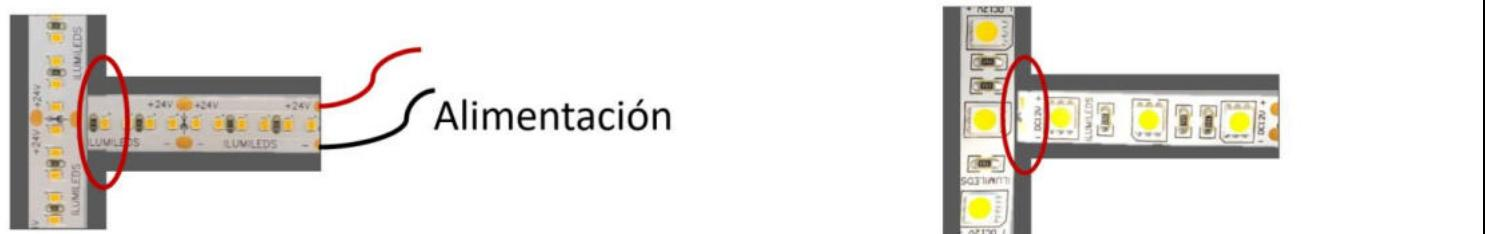
Tira de LED continua en interior de perfil de aluminio con alimentación eléctrica en los extremos
