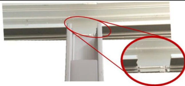
Intersección en perfil sin ceja lateral
