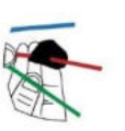
Fig. 1.1 Coloque cinta masilla al primer conductor tanto de alimentación como al de la luminaria.
