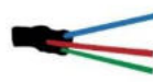
Fig. 1.4 Con los pasos anteriores se generó un sello que evitará el paso de humedad.
