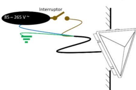
4. Encienda la energía eléctrica y pruebe el funcionamiento del luminario.
