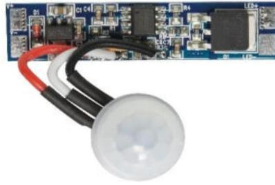
Utilizado como sensor PIR (Infrarrojo Pasivo) para apagar y encender tiras extraplanas de LED monocromáticas en perfiles de aluminio.
