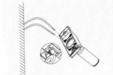
2. Conecte los cables de salida de la fuente de poder (24 V  $\text{DC}$ ) en las terminales del soporte lateral con conector.
