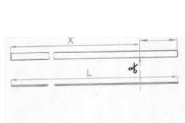
4. Mida la distancia (L) entre las paredes donde se instalarán los soportes (puede usar un cable de acero o hilo como guía) y la distancia de corte de la tira (X).
