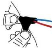
Fig. 1.2 Coloque cinta masilla en el segundo conductor, incorporando este con el primer conductor de ambos cables de alimentación eléctrica y de la luminaria.
