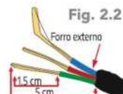
Cable de alimentación de la luminaria
