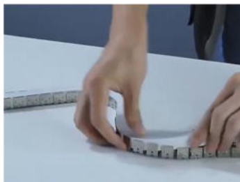
2. Inserte la tira de LEDs en los clips
