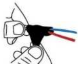
Fig. 1.2 Coloque cinta masilla en el segundo conductor, incorporando este con el primer conductor de ambos cables de alimentación eléctrica y de la luminaria.
