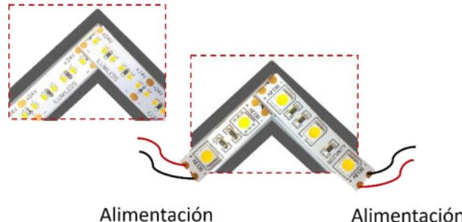
Conecte la tira de LEDs al cable de alimentación usando un cautín de lápiz y soldadura de estaño para soldar en las terminales indicadas (Ver manual de operación de la tira de LEDs o regleta de LEDs utilizada).
