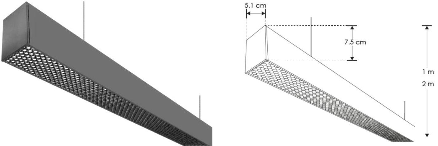
Luminario para colgar de aluminio con cubierta de policarbonato lechosa y filtro tipo rejilla (Louver Honey) de bajo deslumbramiento, altura ajustable mediante los cables de acero, conexión directa a 127 V ~ sin uso de fuentes externas.
