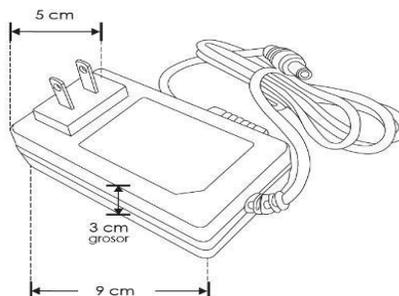
Utilizada para manguera de LEDs, tira de LEDs extraplana y equipo de iluminación LED exclusivamente. Con protección contra corto circuito y sobrecarga.
