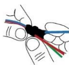
Fig. 1.3 Coloque cinta masilla en el tercer conductor, incorporando este último con los dos anteriores en ambos cables de alimentación eléctrica y cable de la luminaria.
