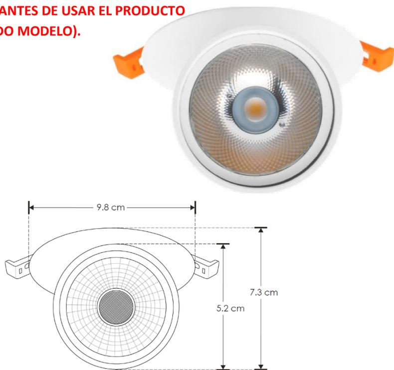
Este producto es usado como elemento de iluminación general en plafones y techos. Compatible con bote integral del número 8 y con lámparas GU10 de hasta 35W. Lámpara no incluida. Incluye base GU10.
