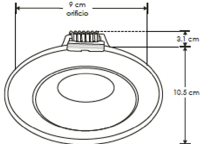
Este producto es usado como difusor de lámparas tipo MR16, GU10 o módulos de leds cuyo diámetro sea igual a 5 cm. Grado de protección IP20 (Para uso en interiores). Características de la base MR16 (incluida) 277 V ~ 35 W (0.28 A) máx. 50/60 Hz
