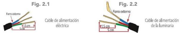
3.- Realice el empalme los conductores 1 a 1 utilizando ambas cintas (cinta masilla y cinta vulcanizable) como lo realizó en el paso 1.
