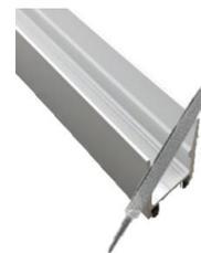
Para realizar figuras como marcos o ángulos a 90°, haga los cortes diagonales, para que, al unir los dos tramos de perfil de aluminio, se forme la figura deseada sin sombras ni obstáculos en el luminario terminado. Puede hacer cortes diagonales para que el luminario tenga luz frontal, interna o luz externa.
