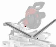
Retire las rebabas que pueda haber en el perfil de aluminio usando una lija fina o lima. Después limpie con una brocha o tela de microfibra el perfil y la mica.
