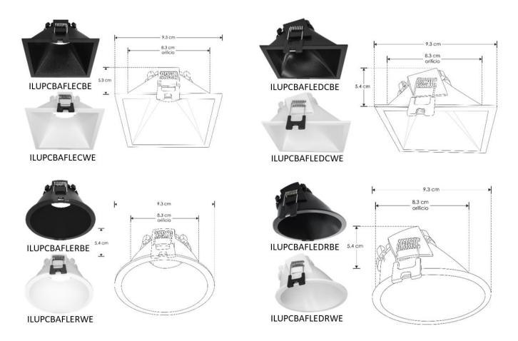
Este producto es usado como difusor de lámparas tipo MR16, GU10 o módulos de LEDs cuyo diámetro sea igual a 5 cm, IP54 para uso en interiores y exteriores. Características de la base incluida:  $277 \text{ V} \sim 50/60 \text{ Hz} 0.28 \text{ A máx}$ . 35 W máx.
