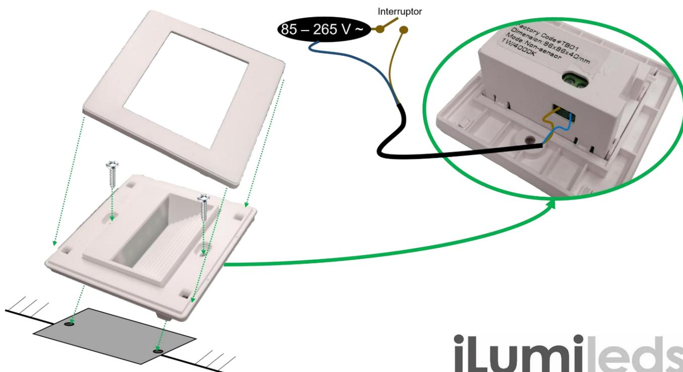
En el modelo ILUPCSTEPSWE la iluminación se mantendrá apagada mientras no detecte presencia de personas, una vez que detecte presencia encenderá automáticamente. Al dejar de detectar presencia se apagará nuevamente pasados 25 segundos. El alcance del sensor es de 3m sin obstáculos. El luminario con sensor de movimiento solo enciende durante la noche.
