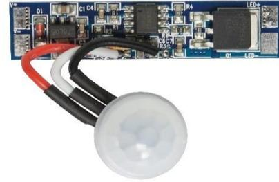
Utilizado como sensor PIR (Infrarrojo Pasivo) para apagar y encender tiras extraplanas de LED monocromáticas en perfiles de aluminio.
