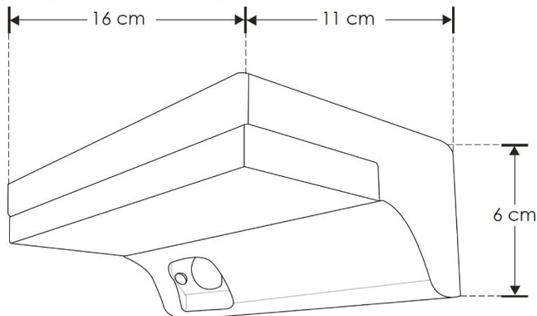
Luminario solar con sensor de presencia y sensor de oscuridad, este producto es usado como elemento de iluminación en fachadas, pasillos, jardines. Para sobreponer, uso exterior. Recomendado para áreas húmedas y de costa. Tiene una autonomía de 8 horas continuas encendido.
