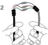
**4.-** Realice el aislamiento cubriendo la cinta vulcanizable desde el conductor de alimentación en dirección del cable de la luminaria.
