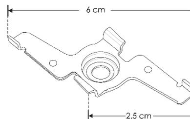
Kit de 2 soportes para sobreponer rieles magnéticos modelos ILUTMAG2624SS e ILUTMAG2651SS
