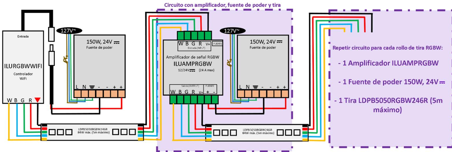
De acuerdo con las características del amplificador pueden utilizarse mas tiras de LED calculando la fuente de poder adecuada y haciendo conexión en paralelo:
