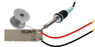
Para agregar cable a un tramo, solde cables calibre 18 en cada terminal.
