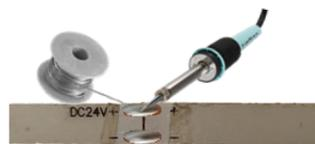
Retire el recubrimiento del adhesivo y solde con cautín de lápiz y soldadura de estaño.
