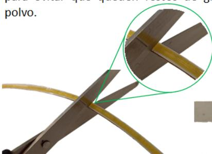
Ubique el punto de corte en la tira de LED señalado con una línea y realice el corte con unas tijeras.
