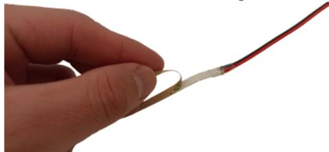
2. Retire el recubrimiento del adhesivo de la parte posterior sin tocar el adhesivo.
