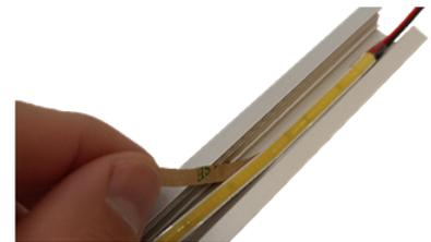
3. Pegue el extremo de la tira de LED, cuidando que esté alineada en el centro del perfil. Haga presión con los dedos para que quede perfectamente adherida. No use ninguna herramienta para pegar la tira de LED ya que puede dañarla. Retire el recubrimiento de la parte posterior conforme va pegando la tira de LED.
