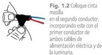
Fig. 1.2 Coloque cinta masilla en el segundo conductor, incorporando este con el primer conductor de ambos cables de alimentación eléctrica y de la luminaria.
