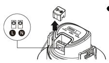
4. Haga las conexiones a la línea eléctrica y coloque la tapa en los bornes de alimentación.
