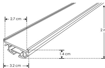
**Material** Kit de perfil de aluminio para mica curva, acabado natural para suspender de 2 m de largo, para recibir tira extraplana o tarjeta de LEDs
