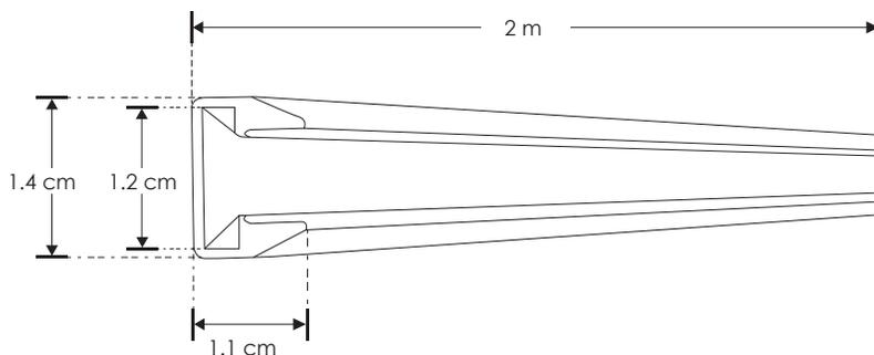
**Material** Perfil rectangular de aluminio acabado natural o negro, de sobreponer de 2 m de largo para recibir tira extraplana de LEDs y cristal templado o acrílico de 8 mm (para repisas iluminadas)
