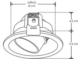
**NOTA:** Este producto es usado como difusor de lámparas tipo MR16, GU10 cuyo diámetro sea igual a 5 cm y con módulos de LED (ILUMOD). Incluye base GU10. Compatible con bote integral de 8.5cm. No incluye lámpara.
