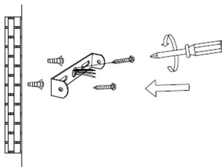
2. Separe la base de sujeción del luminario y coloque los taquetes en el muro. Pase los cables de alimentación por el orificio central de la base.
