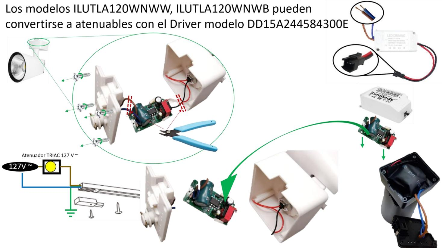
Destape la base del luminario y reemplace el Driver original por el modelo DD15A244584300E. Realice las conexiones y aisle perfectamente. Se recomienda recubrir el driver DD15A244584300E con Thermofit.
