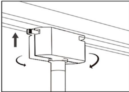
Inserte la parte frontal de la base del luminario en el riel electrificado. Gire y coloque el seguro.
