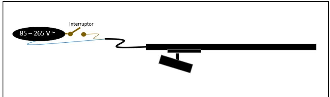
Realice las conexiones del riel electrificado a la línea eléctrica de acuerdo con el diagrama de la imagen-
