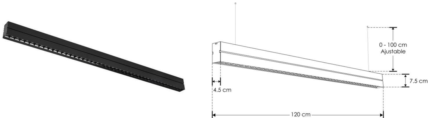
Luminario de LED para suspender en techo, de policarbonato y aluminio, altura ajustable mediante los cables de acero (incluidos).
