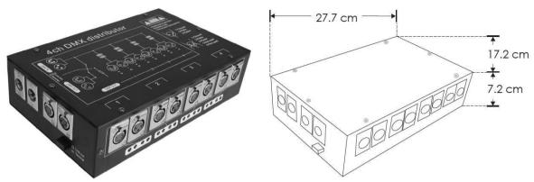
Divisor de una entrada y cuatro salidas opto aisladas (cada una con conector XLR 3 y 5 pines). Utilizado para aislar señales DMX desde un controlador o interfaz hacia equipos DMX remotos.
