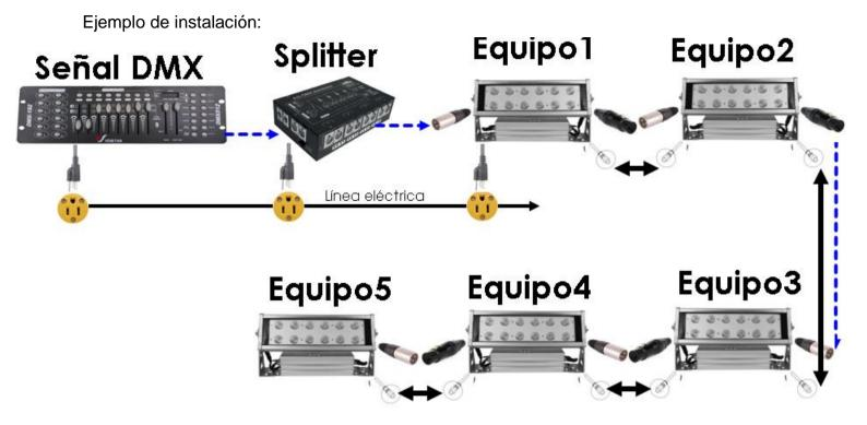
El splitter YDC009 tiene la posibilidad de conectar más de 1 divisor en serie mediante las entradas/salidas llamadas LINK, deje sin oprimir el botón lateral cuando se use como 1er divisor de señal y oprima dicho botón cuando este sea el ultimo divisor.
