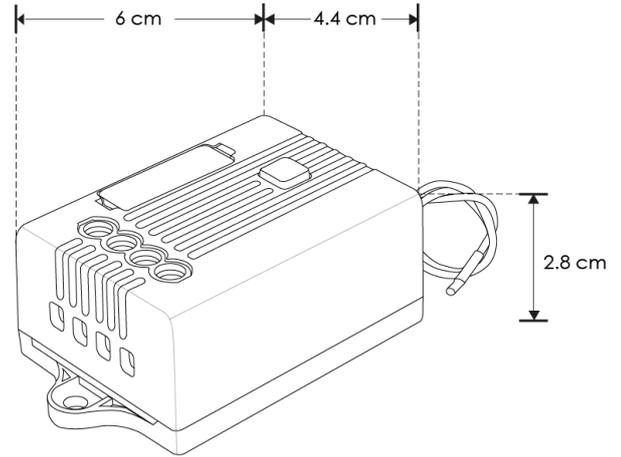
Descripción: Interfaz cinética doble, encendido-apagado 127V ~ 60 Hz. 1270W (635W por canal). Grado de protección IP20.
