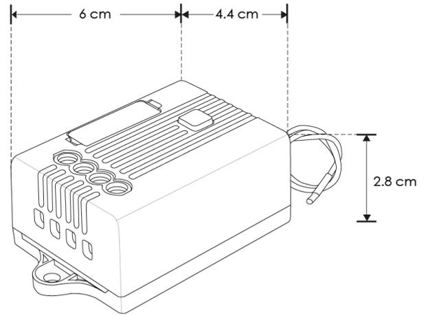
Descripción: Interfaz cinética, encendido-apagado 127-220 V ca 60 Hz, 1270W (10 A). Grado de protección IP20
