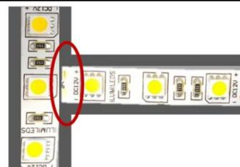
Tira de LED continua en interior de perfil de aluminio con alimentación eléctrica en los extremos
